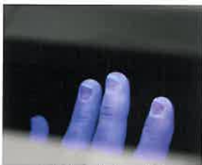
Prüfung des Hautschutzes mittels UV-Lampe.
