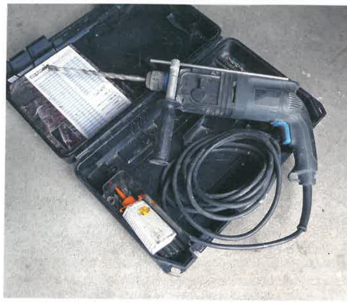
Auf der Baustelle muss der Anwender vor dem Gebrauch des Werkzeugs und des Zubehörs – hier ein Bohrhammer mit Bohrer – eine Sichtkontrolle auf Beschädigungen durchführen.
