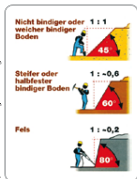
Abb. 3: Böschungswinkel
