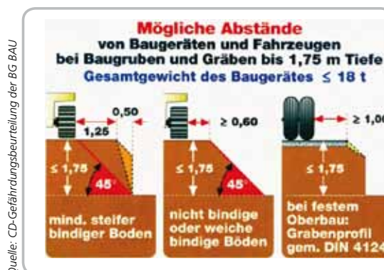
Abb. 2: Abstände bei Baugruben und Gräben bis 1,75 m
